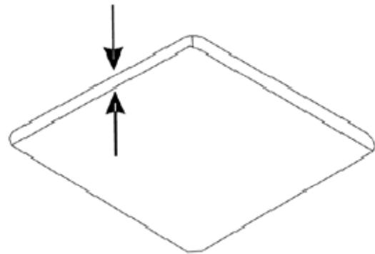
Die Oberfläche vor der Montage der Dachhaube gründlich mit einem geeigneten Reinigungsmittel reinigen.
