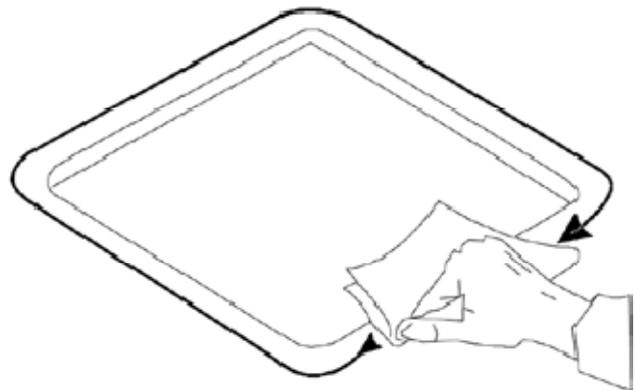
Ausreichend geeigneten Klebstoff auf die Ränder der Dachhaube auftragen, wie rechts gezeigt.
