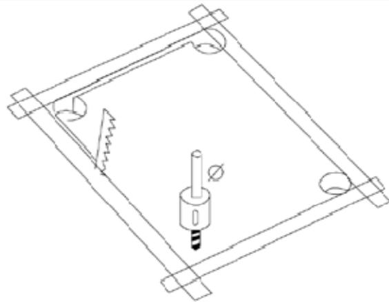
Vor der Montage: Das Dach muss 25 – 60 mm stark sein. Sicherstellen, dass das 12-V-Kabel entsprechend verlegt wurde.
