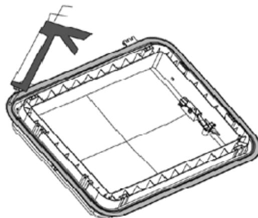
Dachhaube im Ausschnitt platzieren und sicherstellen, dass die Scharniere zur Vorderseite des Fahrzeugs zeigen.
