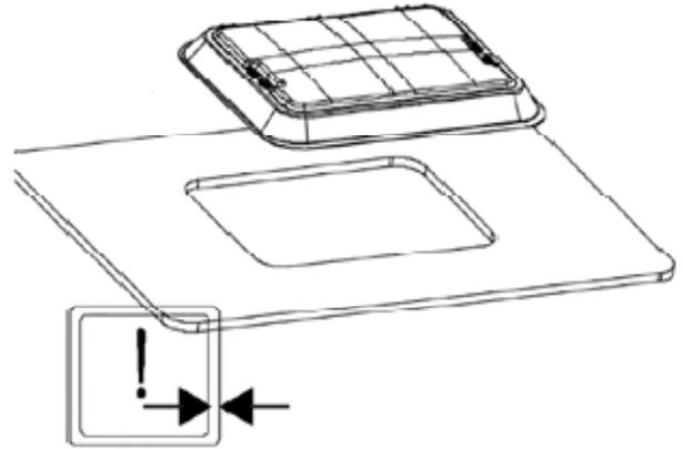
Die mitgelieferten Halterungen in die Schlitzte in der Dachhaube einsetzen und die bereitgestellten Schrauben je nach Stärke des Dachs verwenden.
